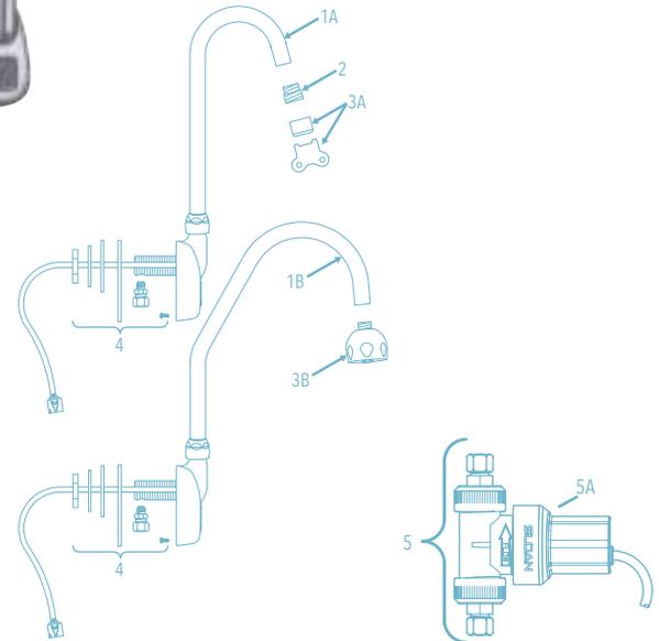
¶ PARA MONTAR LA LLAVE A UNA SUPERFICIE ENTRE 10 MM (0.41") Y 25 MM (1.00") DE ESPESOR, USE EL HERRAJE QUE SE MUESTRA ABAJO.
