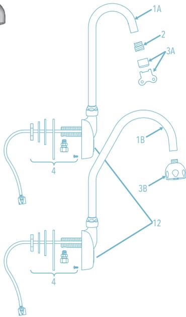
†† PARA MONTAR LA LLAVE EN UNA SUPERFICIE ENTRE 10 MM (0.41") Y 25 MM (1.00") DE ESPESOR, USE EL HERRAJE QUE SE MUESTRA ABAJO.
